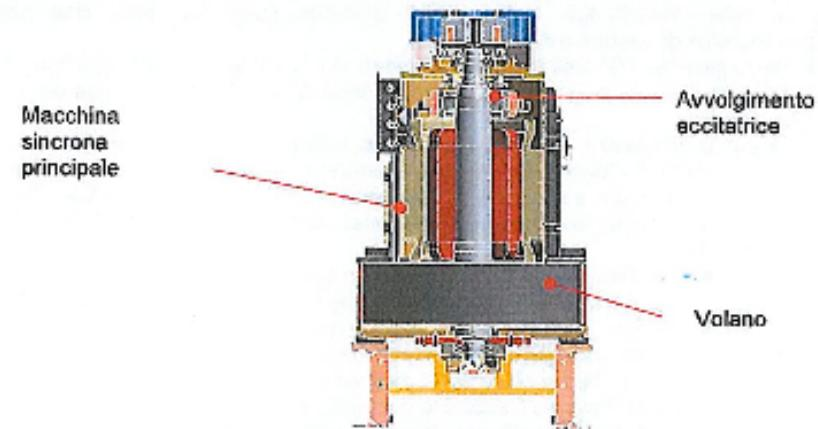
Fig. 5: Accumulatore inerziale PowerBridge
